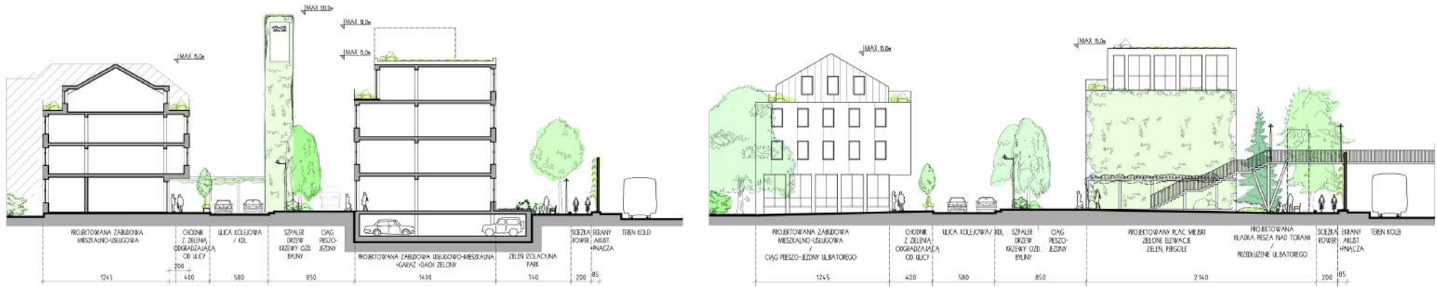
II.F.2. Wariant projektowany ulicy Kolejowej – przekroje. Po lewej – największy przekrój na odcinku pomiędzy ul. Sikorskiego i ul. Batorego; po prawej – przekrój przez nowy skwer na osi ul. Batorego. Wypracowane rozwiązanie jest wynikiem kompromisu pomiędzy oczekiwaniami mieszkańców i inwestorów wypracowanego w procesie partycypacyjnym. Uwzględnia podcienia i usługi w parterach, przeniesienie Park&Ride do garażu podziemnego, przesunięcie ścieżki rowerowej w pobliże terenów PKP. Perspektywę ulicy Kolejowej zamyka punkt orientacyjny – zielona wieża informacyjna przy Dworcu PKP. Po prawej widoczna projektowana kładka piesza z windą dla osób z niepełnosprawnościami i rowerzystów. Opracowanie własne Konsorcjum Autorów.
